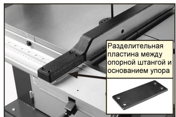
Рисунок 2. Установленная опорная штанга.
