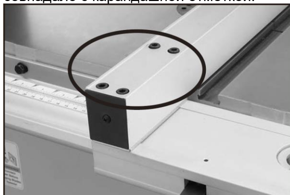
Рисунок 1. Для замены упора необходимо выкрутить четыре винта.
