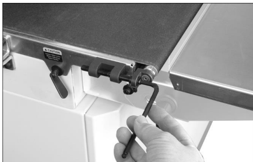
Рис. 7-3: регулировка натяжения ленты
